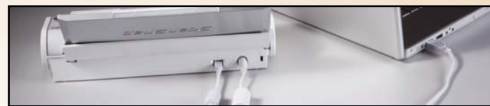
Le S300M peut être alimenté par le secteur ou par une prise USB
